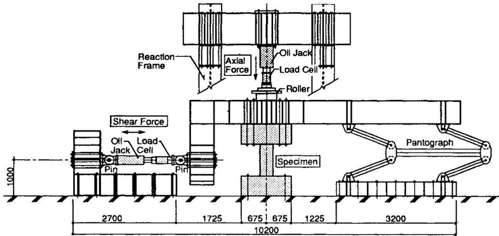
Fig. 2 Loading apparatus
