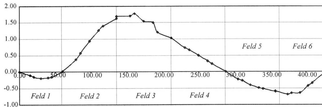
Fig. 2 1. Vertical Eigenmode of the Hainburg bridge
