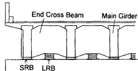
*Fig. 3 LRB-SRB Isolation System*
