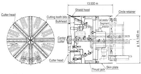
Fig. 7 Slurry shield
