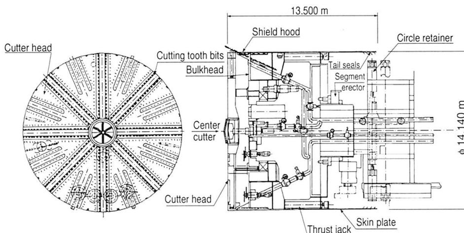
Fig. 7 Slurry shield
