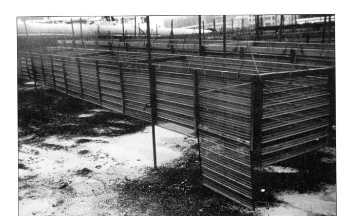
Fig. 4 Metal mould for keelblocks
