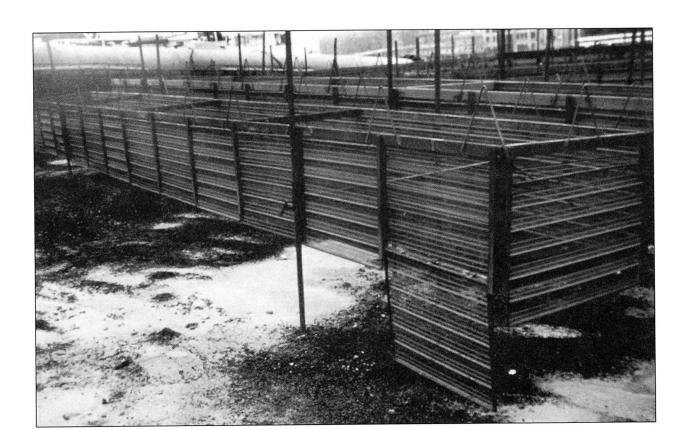
Fig. 4 Metal mould for keelblocks
