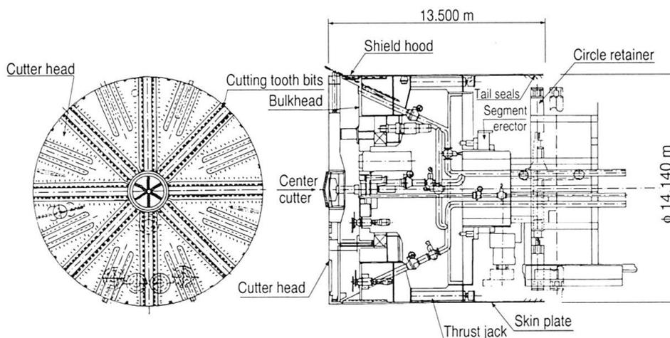
Fig. 7 Slurry shield
