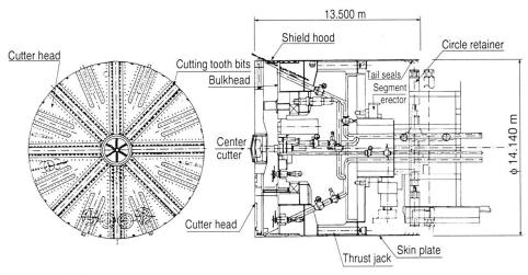
Fig. 7 Slurry shield
