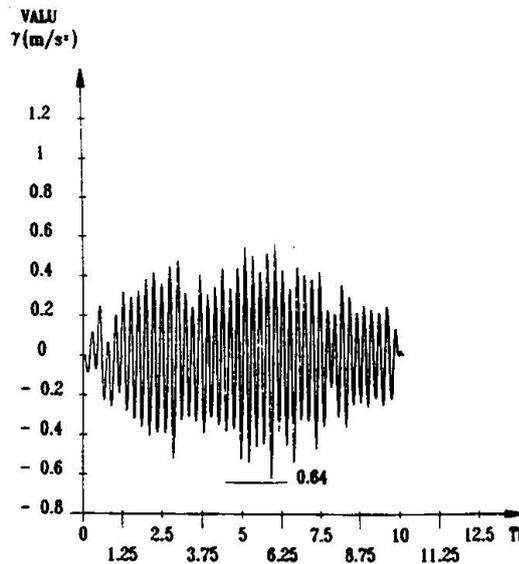
0A15 FH V=274.6 km/h ACCELERATION AT MID SPAN
