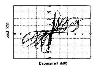
Fig. 7 Load-Interface Slip of FC-3
