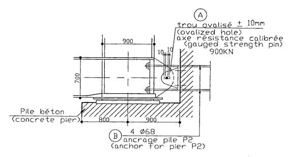
Fig 9: appareil d'appui et ancrage
