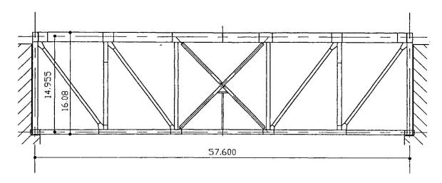
Fig 3: Elévation des poutrestreillis latérales
