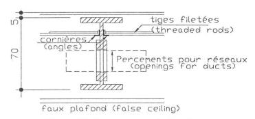
Fig 7: Liaison poutre et plancher
