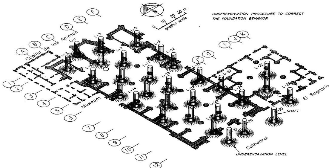
FIG 5 SHAFT AND RADIAL UNDEREXCAVATION BORINGS LOCATION
