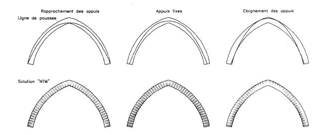
Fig. 4 Arc soumis à un éloignement et à un rapprochement de ses appuis.
