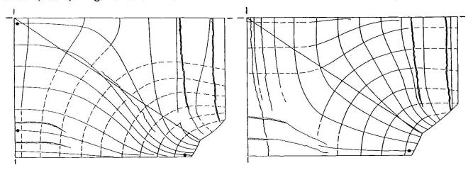
Bild 8: Spannungstrajektorien und Risse am kuppelartigen Kreuzgewölbe infolge einer Auflagerverschiebung a) Oberseite b) Unterseite
