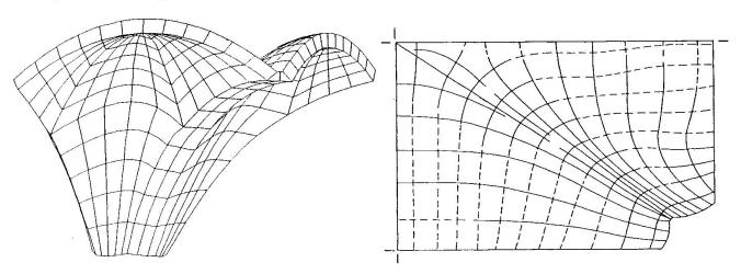
Bild 9: Kreuzgewölbe mit gebusten Kappen a) Elementnetz b) Spannungstrajektorien an der Oberseite
