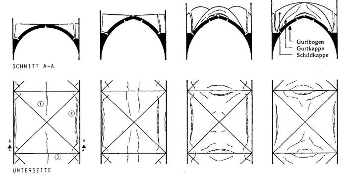
Bild 2: Typische Rißbilder infolge einer horizontalen Auflagerverschiebung
