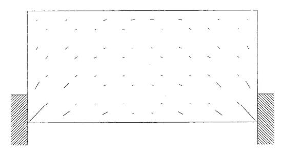
Fig. 6 Panneau de NTM sur deux appuis et soumis à son propre poids.
