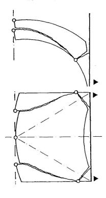
Bild 4: Bewegungsmechanismus am kuppelartigen Kreuzgewölbe
