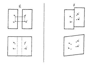
Fig. 3 Fractures élémentaires et leur représentation sous forme de déformation initiale.
