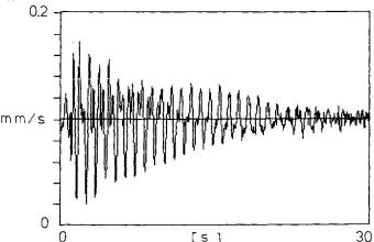
Bild 3: Freie Schwingung nach Impulserregung (Sprung)
