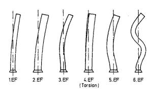
Bild 8: Darstellung der Eigenschwingungsformen (ungerissener Zustand)
