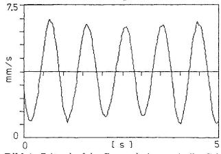
Bild 6: Zeitverlauf der Bogenschwingung (volles Geläut)
