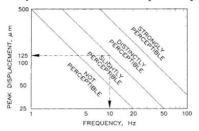
FIGURE 2: VIBRATION ANNOYANCE SCALE
