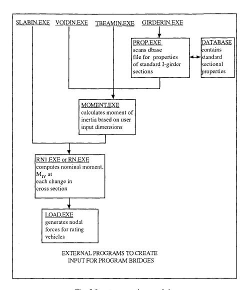
Fig. 2 Input generation module
