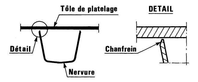
Fig. 2 Préparation des bords de tôle constituant les nervures.
