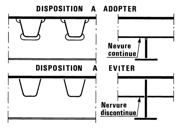
Fig. 3 - Assemblage nervures-pièce de pont
