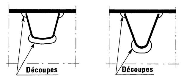
Fig. 4 - Découpage de l'âme des pièces de pont
