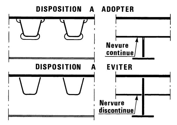
Fig. 3 - Assemblage nervures-pièce de pont
