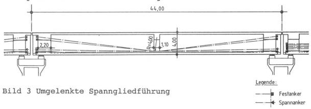
Bei zwei Überbauten - je einer mit einem der beiden Spannverfahren - werden die Spannglieder in Feldmitte über einen Umlenksattel geführt (Bilder 3 und 4). Es ist dort ausreichend Platz vorhanden, sie in einer Lage anzuordnen, so daß ihr Schwerpunkt sehr tief zu liegen kommt. Es sind 16 Spannglieder erforderlich. Die Spannanker sind wechselseitig in den unteren Lagen angeordnet.
