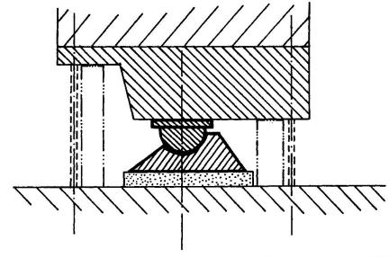
L'amorce du mouvement de basculement, à partir de la position verticale initiale, après démontage de l'encastrement provisoire en pieds de pylône, a été effectuée au moyen de deux câbles mouflés, à l'aide de tireforts, jusqu'à ce que l'inclinaison du pylône soit suffisante pour compenser l'effet de rappel des câbles 19T15, du fait de leur propre poids, le mât devenant alors le propre générateur du mouvement.
