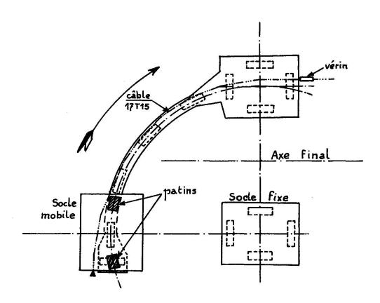
Le mouvement de rotation est engendré par un câble de précontrainte 17T15 accroché au socle mobile, dévié ponctuellement par des sabots métalliques fixés à la longrine, et tiré par un vérin avaleur de câble, à double plateau, de 350 t. de force utile, ancré derrière la semelle d'arrivée.
