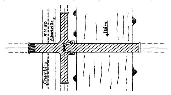
Cet ouvrage est un pont à haubans en béton précontraint, à deux travées, de portées respectivement 102 m. au-dessus de l'Isère et 60 m. au-dessus de la RN.90, et comportant un mât central en forme de A, incliné à 20° vers l'arrière.
