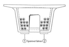
Bild 5 Ankeransicht bei gerader Spanngliedführung
