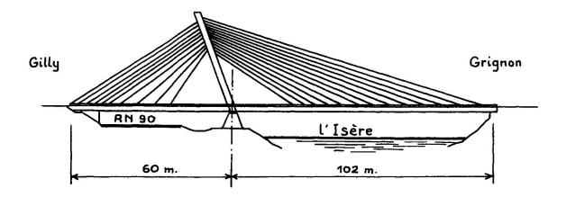
Outre l'appui central, sous le pylône, constitué de deux socles de forme pyramidale, et situés sous chacune des jambes du mât, l'ouvrage est simplement appuyé sur une culée chevêtre, en rive gauche, côté Grignon, tandis qu'il comporte, en rive droite, une culée massive dans laquelle est encastré le tablier et constituant le contrepoids d'équilibrage de ce fléau dissymétrique.
