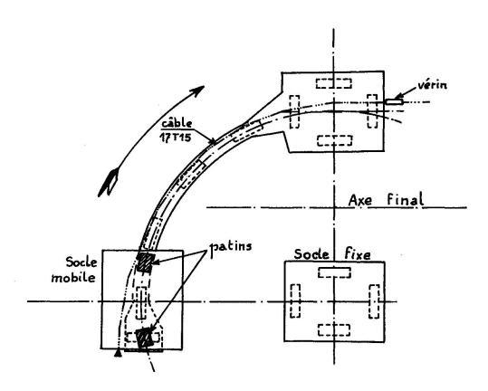
Le mouvement de rotation est engendré par un câble de précontrainte 17T15 accroché au socle mobile, dévié ponctuellement par des sabots métalliques fixés à la longrine, et tiré par un vérin avaleur de câble, à double plateau, de 350 t. de force utile, ancré derrière la semelle d'arrivée.
