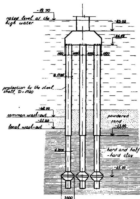
Fig. 1 Pier diagram.
