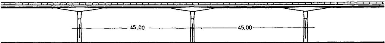
Beispiel 2: Plattenbrücke mit Vouten auf extrem schlankem Unterbau; Ortbeton mit Vorspannung mit nachträglichem Verbund. Unterbau aufgelöst in eine Verbundkonstruktion aus Stahlbetonstützen und Stahl-Fachwerkkonsolen.
