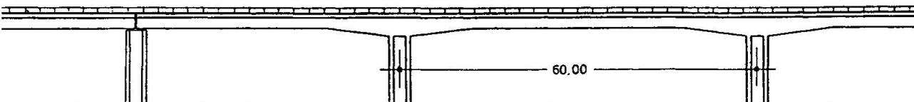
Die Beispiele deuten die großen Variationsmöglichkeiten an, die der Träger mit veränderlicher Bauhöhe bietet.
