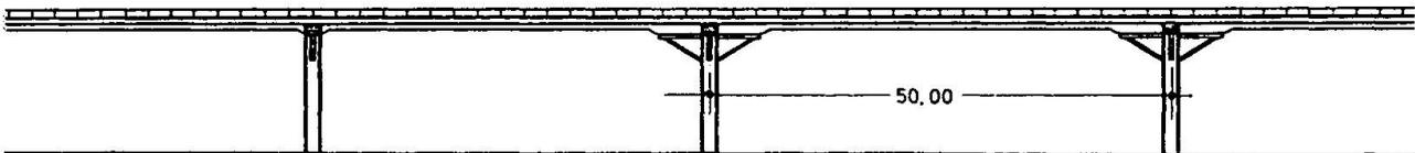
Beispiel 3: Hohlkasten mit Vouten in Ortbeton oder in Segmentbauweise mit externer Vorspannung ohne Verbund. Stützen aufgelöst in 2 schlanke Scheiben mit verschiedenen Möglichkeiten der Lagerung:
