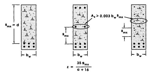
Fig. 2 Crack spacing parameter z.
