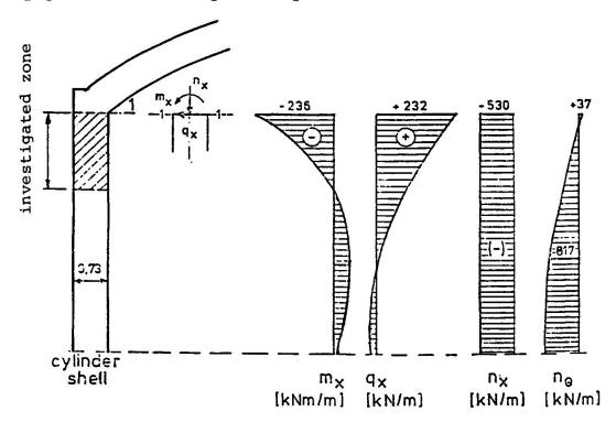
Fig. 5 DISTRIBUTION OF FORCES IN THE CYLINDER SHELL
