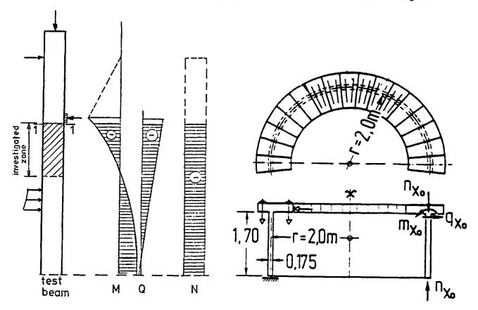
Fig. 6 FORCES FOR THE BEAM-CANTILEVER SPECIMEN
