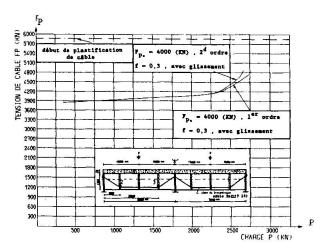
Fig. 10 : Evolution de la tension du câble 2-3
