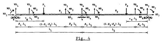
Il est facile de calculer ces efforts réduits à partir des efforts dans le câble  $F_{p(1)}$ ,  $F_{p(2)}$ , ...  $F_{p(6)}$  supposés connus; par exemple, pour le déviateur 2, on a :  $HD_2 = F_{p(2)} - F_{p(1)} \cos \alpha_1$ ;  $VD_2 = F_{p(1)} \sin \alpha_1$ ;  $MD_2 = HD_2$  e<sub>2</sub> où  $\alpha_1$  désigne l'angle du segment de câble (1-2) par rapport à l'horizontale.
