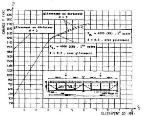
$\frac{\text{Fig. 9}}{(D=2, D=3)}$ : Charge-glissement aux déviateurs
