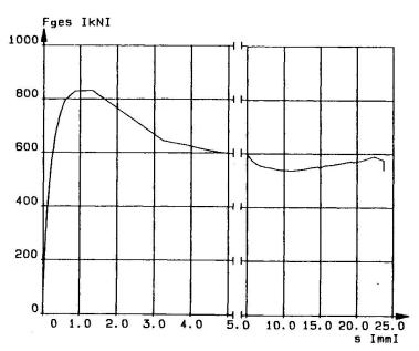
Bild 5: Typische Kennlinie einer kombinierten Verankerung
