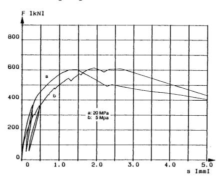
Bild 6: Einfluß der Vorspannung auf eine kombinierte Verankerung
