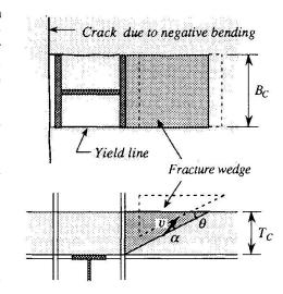
Fig. 3 Failure mode
