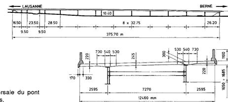
FIGURE 1 Elévation et section transversale du pont mixte utilisé pour les essais.
