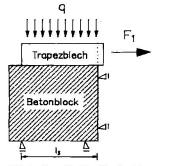
Bild 4: Pull-Out Versuch
