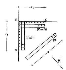
Bild 6: Verteilung der Betondruckspannungen im Abstützungsbereich der Druckstrebe
