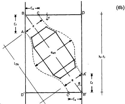
Bild 5: Betondruckfeldmodell
