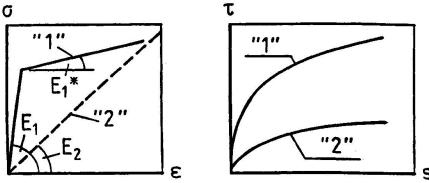
Abb. 2: Verwendete Werkstoffgesetze (schematisch)
