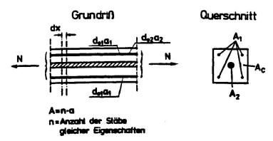
Abb. 1: Gemischt bewehrter Dehnkörper (schematisch)
