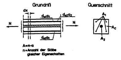
Abb. 1: Gemischt bewehrter Dehnkörper (schematisch)
