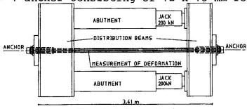
fig. I: test alignement scheme
