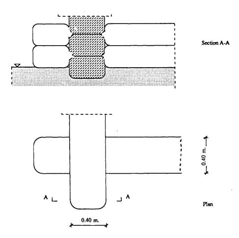
Fig. 5 Particulier connexion d'angle
