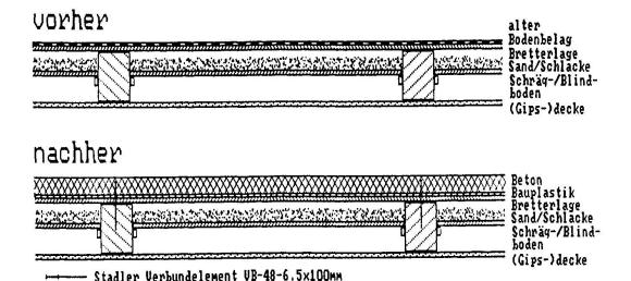
Bild 2: Holz-Beton Verbunddecke im Altbau
