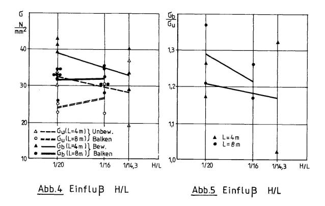
Verfolgt man diese Schwankung der Werte bei den Lamellenbalken mit gleicher Länge L, so ergibt sich ein Absinken des Verhältnisses  $\mathfrak{Sb}/\mathfrak{Su}$  mit dem Ansteigen des Verhältnisses  $\mathfrak{H}/L$ .
