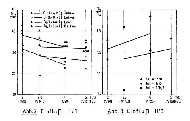
Veranschaulicht man diese normalen Bruchspannungen aufgrund des Verhältnisses H/B (Abb.2) wird sichtbar, dass die Normalspannung mit dem gleichzeitigen Ansteigen des Verhältnisses H/B sinkt, wenn das H/L-Verhältnis konstant bleibt.
