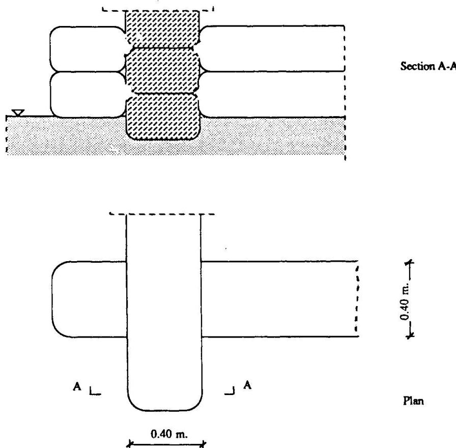
Fig. 5 Particulier connexion d'angle
