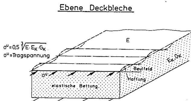
Abb. 4: Elastische Bettung der druckbeanspruchten Deckbleche auf der Kernschicht
