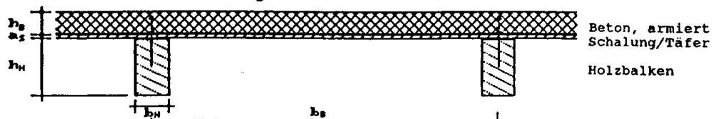
$$\begin{aligned} E_{\text{Holz}} &= 10'000 \text{ N/mm}^2 \quad (\text{SIA 164}) & E &= E_{\text{Holz}} \\ E_{\text{Beton}} &= 21'000 \text{ N/mm}^2 \quad (\text{SIA 162}) & n_B &= E_{\text{Beton}} / E_{\text{Holz}} \\ E_{\text{Stahl}} &= 210'000 \text{ N/mm}^2 \quad (\text{SIA 162}) & n_S &= E_{\text{Stahl}} / E_{\text{Holz}} \\ F_e &= \text{Stahlquerschnitt in der Mitte der Betonplatte} \\ x &= \text{Lage der neutralen Achse über Unterkante Holz} \end{aligned}$$
