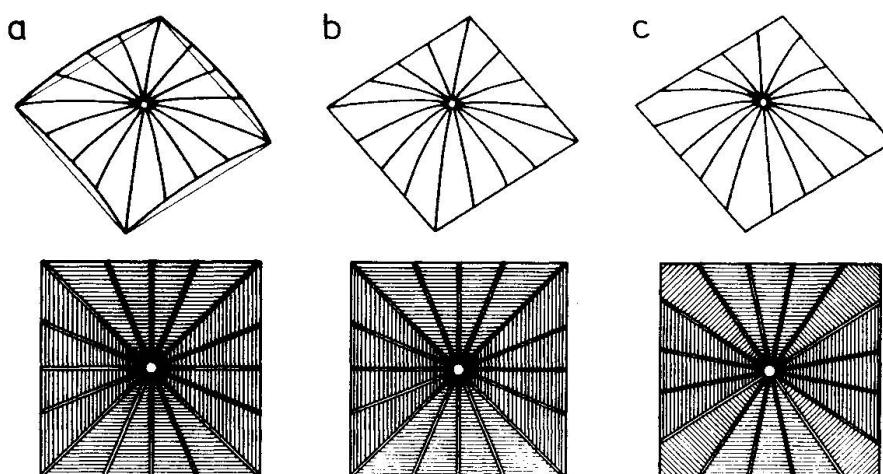
**Fig.5** Mögliche Deckenformen über quadratischem Grundriß mit Darstellung der Balkenlage im oberen Bildteil und Untersicht der Decke im unteren Bildteil für
