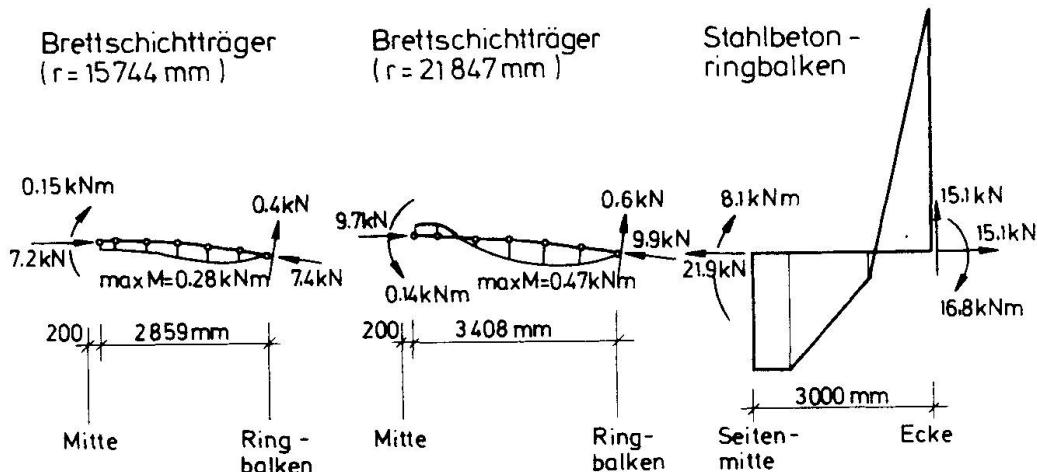
**Fig.7 Reaktionskräfte und Momentenverläufe in dem Balken für eine Deckenbelastung von 1.0 kN/m<sup>2</sup>**
