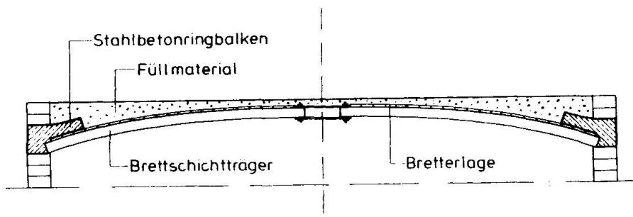
**Fig.4** Schnitt durch die Decke der Fig. 1
