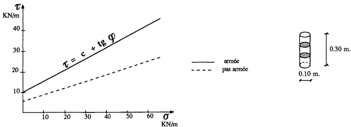
Fig. 1 Comparaison de différents essais
