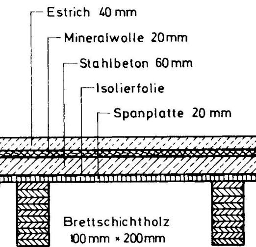
**Fig.1** Querschnitt einer Holzbalkendecke
