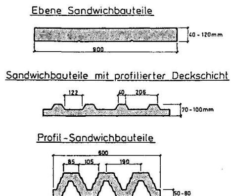
Abb. 3: PUR-Sandwich-Querschnitte
