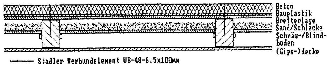
**Bild 2:** Holz-Beton Verbunddecke im Altbau
