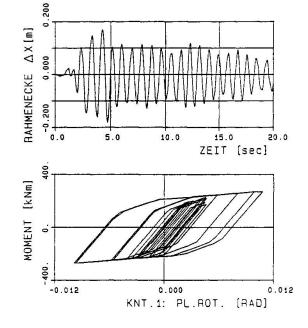
Bild 7 Ergebnisse der Berechnung unter Erdbebenlast
