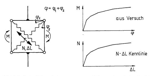
Bild 5 Modell für die Anschlußpaneele der Träger-Stützen-Verbindungen mit zugehöriger Kennlinie
