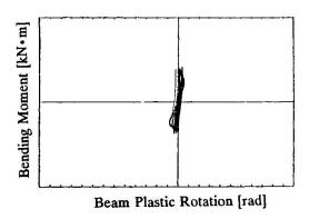
Bild 2 Momenten-Rotationskurven des Versuchs J3
