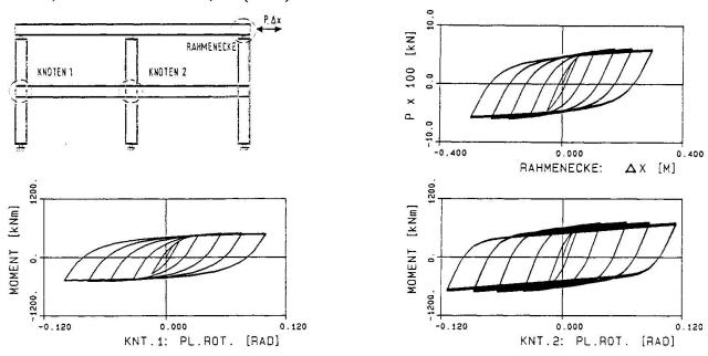
Bild 6 Ergebnisse der verformungsgesteuerten Berechnung
