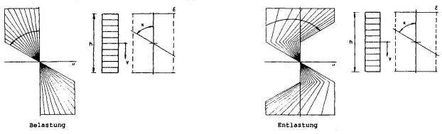
Bild 3 Berücksichtigung von Eigenspannungen und der Belastungsgeschichte
