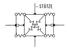
Bild 4 Modell der Träger-Stützenverbindung
