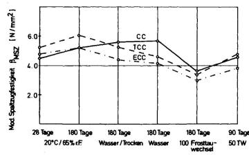
Fig. 6 Verbundfestigkeit von Reparatursystemen bei unterschiedlicher Lagerung
