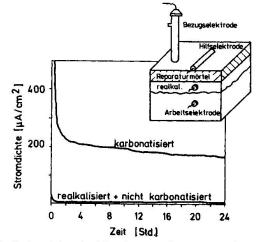
Fig. 8 Realkalisierungsfortschritt für unterschiedliche Reparatursysteme, Unterbetone und Lagerungsbedingungen
