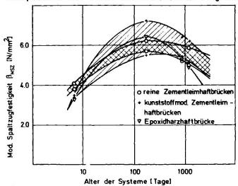
Fig. 7 Verbundfestigkeit der Reparatursysteme in Abhängigkeit vom Alter
