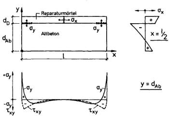
Dehnung können über die Zugbruchdehnung hinaus noch Zugspannungen aufgenommen werden [4]. Es kommt demnach nicht zu einem reißverschlußartigen Ablösen größerer Bereiche, sondern zur Ausbildung sogenannter geschwächter Zonen über eine Länge von einigen Zentimetern an den freien Rändern der Systeme und zwar normalerweise im weniger festen Unterbeton (Fig. 3). Solchermaßen geschwächte Ränder konnten in experimentellen Untersuchungen nachgewiesen werden.
