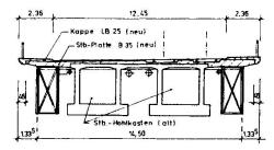
Querschnitt (nach der Instandsetzung)
