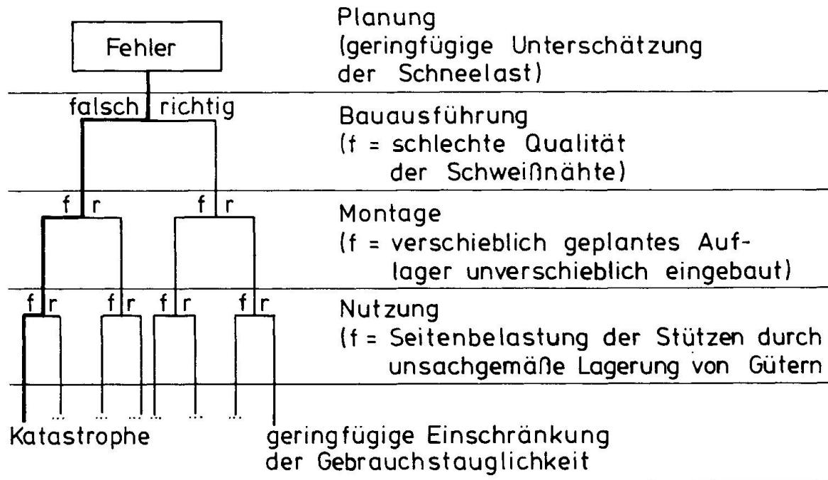
Bild 3 Ereignisbaum Stützen-Binder-System
