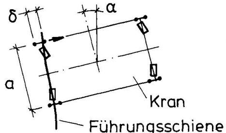
Bild 4 Kranschrägstellung
