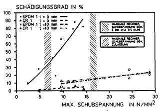
Bild 2: Schädigungsgrad in Abhängigkeit von der maximalen Schubspannung EPDM 1 und CR 1
