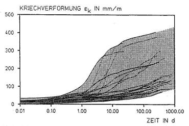
Bild 1a: Kriechkurven aus allen Versuchen mit EPDM-Qualitäten
