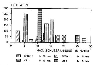
Bild 3: Gütewerte für EPDM 1 und CR 1 Lagerproben
