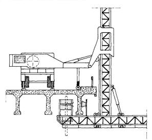
Sur la figure 4 on voit qu'émetteur et récepteur sont portés ensemble par la passerelle. La synchronisation des mouvements en est ainsi simplifiée par rapport à la version précédente. La mise en place est sensiblement plus rapide.
