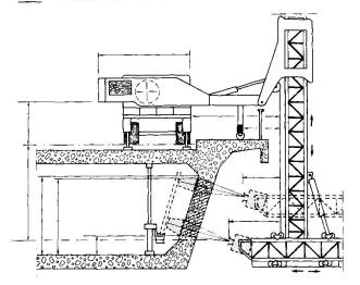
La figure 2 montre la disposition de l'émetteur et du récepteur dont les déplacements sont complètement indépendants. La synchronisation des mouvements est obtenue au niveau des commandes.
