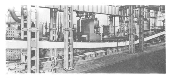
Fig. 3 Spannbetonträger A3 im Prüfstand mit einer Durchbiegung von w = 65 cm in der Mitte
