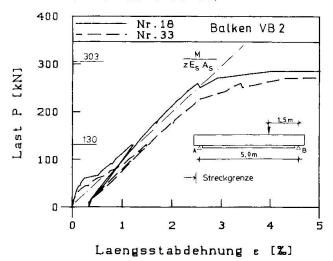
Fig. 10 Längsstabdehnungen (VB2, Meßstellen 18 und 33)
