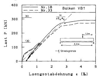
Fig. 8 Längsstabdehnungen (VB1, Meßstellen 18 und 33)
