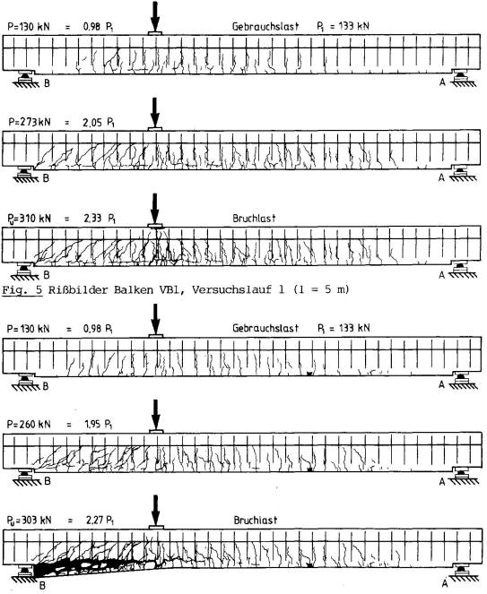
Fig. 6 Rißbilder Balken VB2, Versuchslauf 1 (1 = 5 m)
