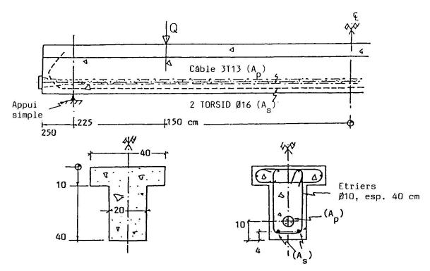
a) Poutres pour béton à résistance 50 MPa
