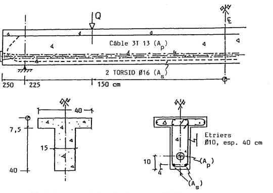
b) Poutres pour béton à résistance 85 MPa
