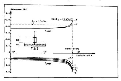
Bild 5: Trägerversuch T2/2; Dehnungen bei Oberlast
