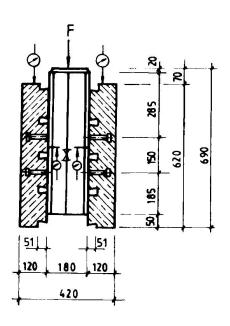
Bild 1: Scherversuchskörper
