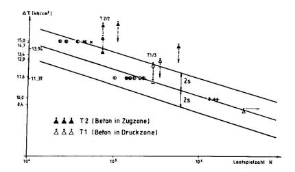
Bild 8: Zeitfestigkeiten der Scher- und Trägerversuche
