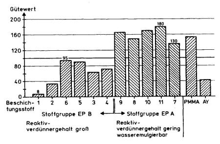
Bild 1: Gütewerte der Beschichtungssysteme
