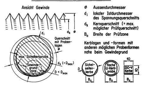
Figur 4:Anordnung von gekerbten Rund- und ISO-V-Proben in Gewindestange
