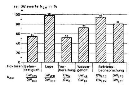
Bild 2: Relative Gütewerte kgw von Epoxidharzbeschichtungsstoffen für Betoneigenschaften und Betriebsbeanspruchungen
