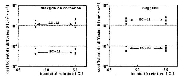
Fig. Coefficients de diffusion de CO2 et O2 dans la pâte de ciment durcie mesurés à 48 et 55 %.
