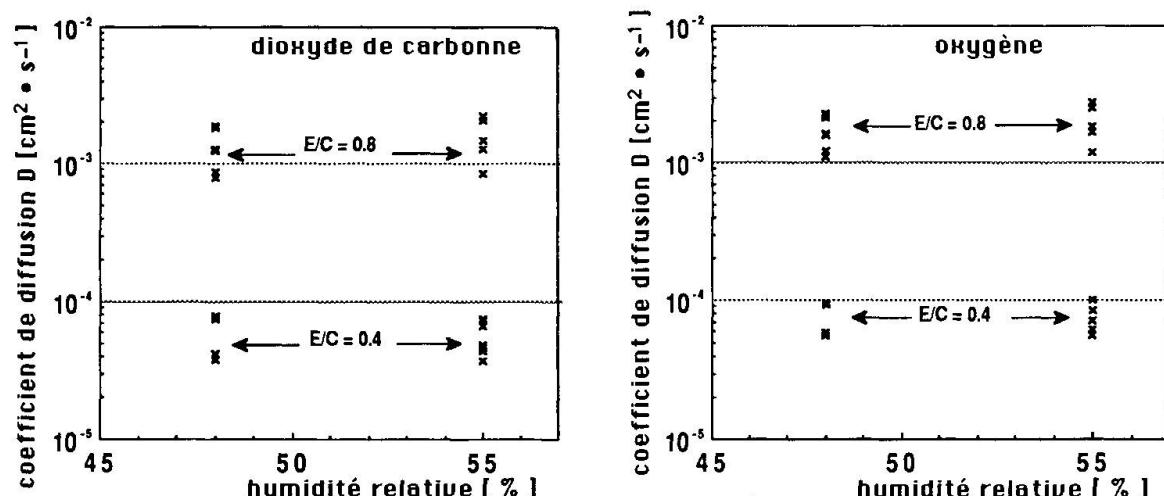
Fig. Coefficients de diffusion de CO<sub>2</sub> et O<sub>2</sub> dans la pâte de ciment durcie mesurés à 48 et 55 %.
